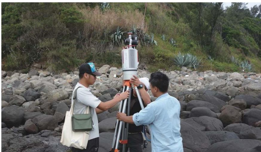
圖4 地面型雷射掃描儀外業作業。
