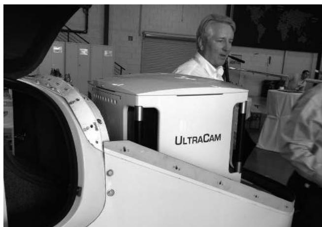
圖17 配置於飛機機鼻艙內之空載掃描儀與搭配全尺幅數位相機（微軟ULTRACAM），可同時進行雷射掃描與數位航空影像拍攝（攝影：胡子威）。
