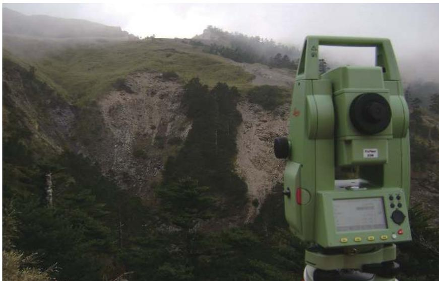
圖1 以Leica全測站進行崩塌地的地形測量來偵測崩塌地變遷。
