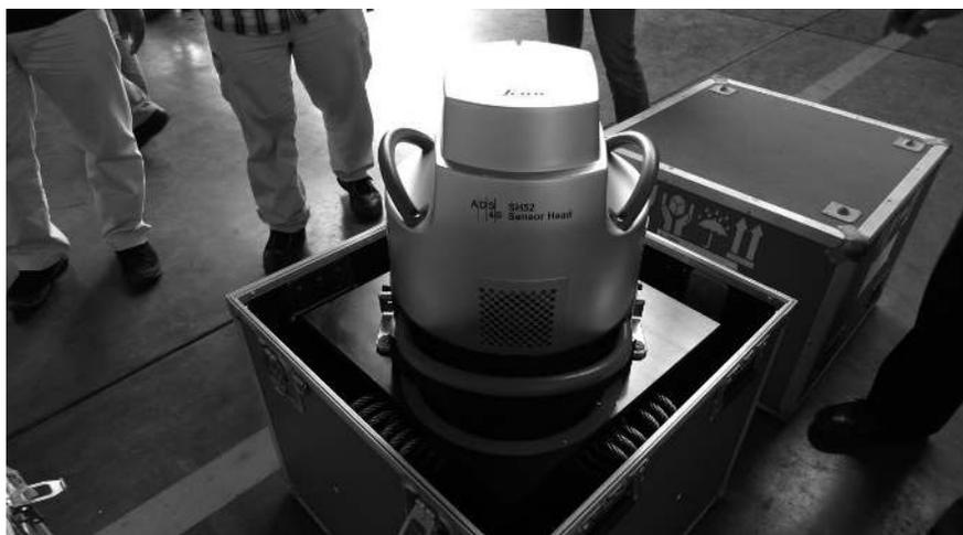
圖18 配合空載掃描儀之掃描式數位相機（萊卡ADS40）（攝影：劉時宏）。
