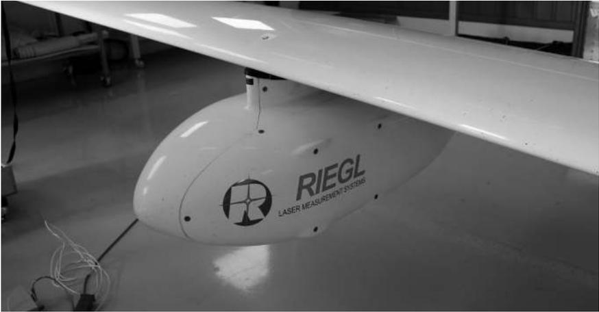
圖15 設置於機翼下來艙內之空載掃描儀（攝影：胡子威）。
