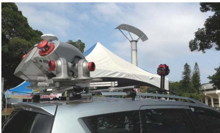
圖12 設置於車輛頂部之車載掃描儀（攝影：胡子威）。
