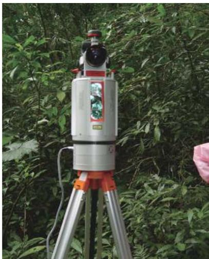
圖3 地面型雷射掃描儀 (Riegl VZ400) (攝影：胡子威)。
